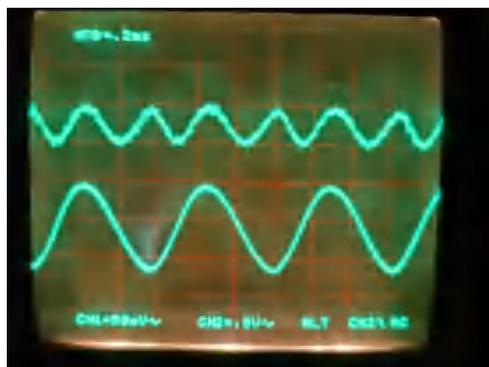
图 13 倍频失真实验图(333V)
