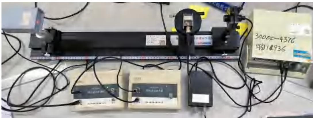
图 8 声光模拟通信实验光路
