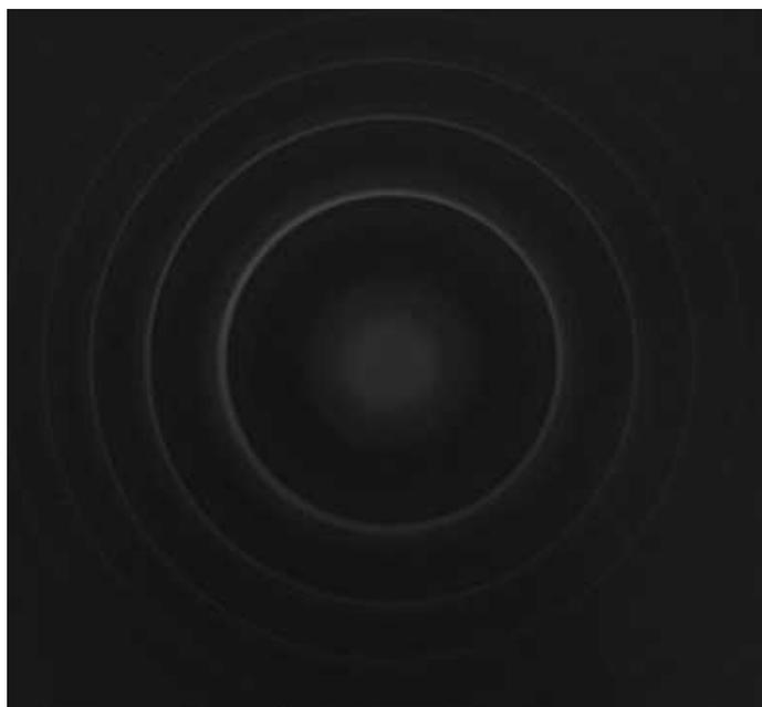
图 11 无磁场时塞曼分裂观测图(579.06nm)
