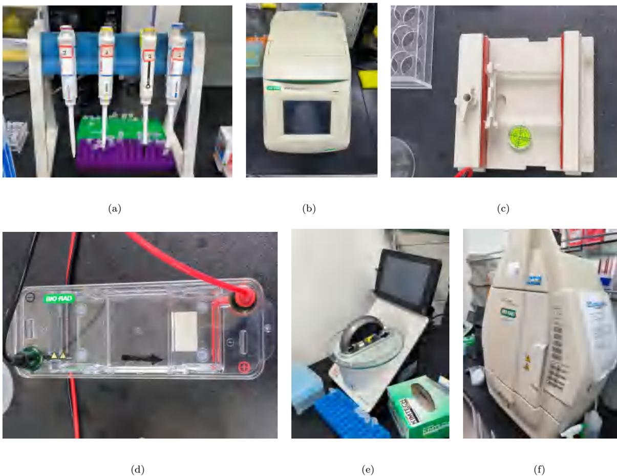
图 7 (a) 移液枪 (b)PCR 仪 (c) 凝胶制备器 (d) 电泳仪 (e) 超微量核酸蛋白测定仪 (f) 凝胶成像分析仪
