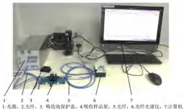
图 5: 吸收光谱及颜色分析实验装置
