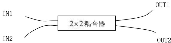
图1 2×2耦合器实验光路图
